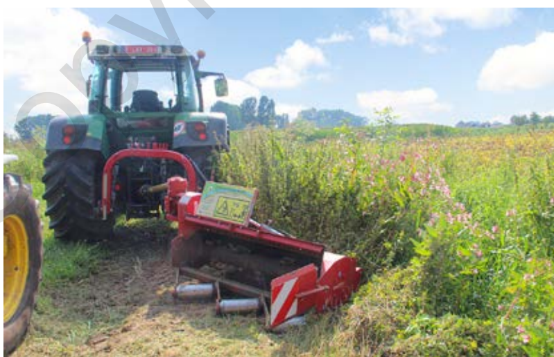
Een standaard klepelmaaier in verstek was uitgerust met brede klepels, die door hun kracht het maaisel wegwerpen van de rand.
