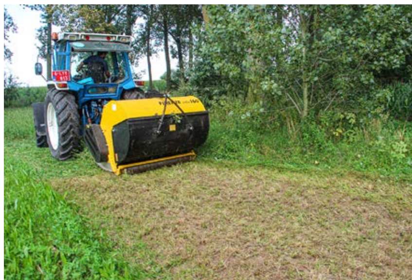
De Firenze Erba 160 is een gedragen maaicombinatie met een kleine opvangbak.
