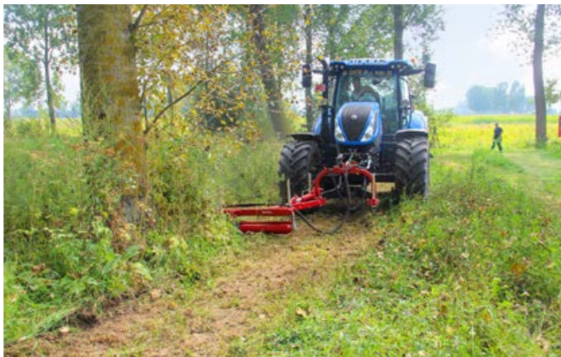
Bij de Breviglieri-palenmaaier doet de grote schijf de maaier wegklappen bij het raken van een paal of boom.
